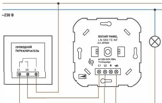
Рисунок 3. Схема подключения панели 500-проходным переключателем.
