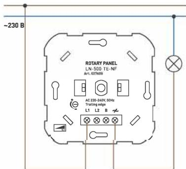
Рисунок 2. Схема подключения панели 500
